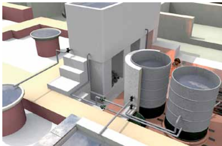
Detall calderes, dipòsit elevat i labrums o piques d'aigua
