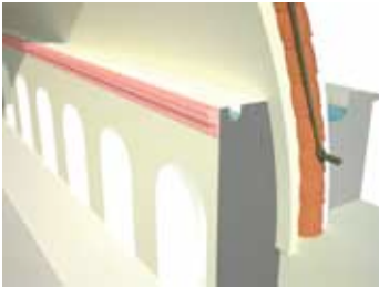
Sistema interior i exterior de recollida d'aigua de la coberta del caldarium
